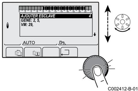
4. L'écran qui s'affiche permet de choisir des numéros de chaudières suiveuses à ajouter au réseau. Les numéros 2 à 10 sont dédiés aux générateurs, et les numéros 20 à 39 aux VM iSystem. Tourner le bouton rotatif pour faire défiler les numéros et appuyer pour valider le numéro choisi. Appuyer sur  $\square$  pour retourner à la liste précédente.
