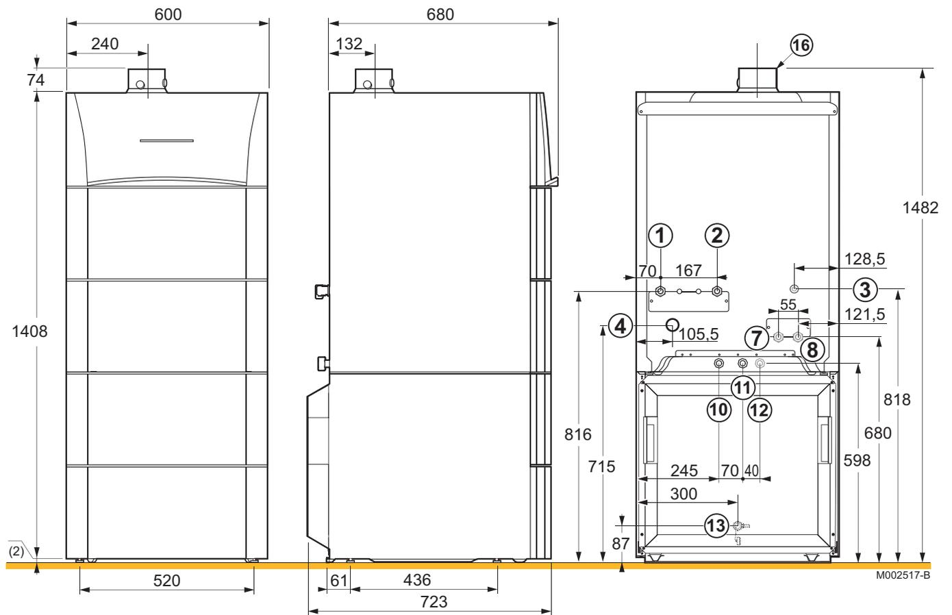
■ Chaudière avec préparateur d'eau chaude sanitaire de type 160SL
