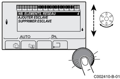
3. Pour ajouter un appareil suiveur au réseau, sélectionner **AJOUT ESCLAVE**.
