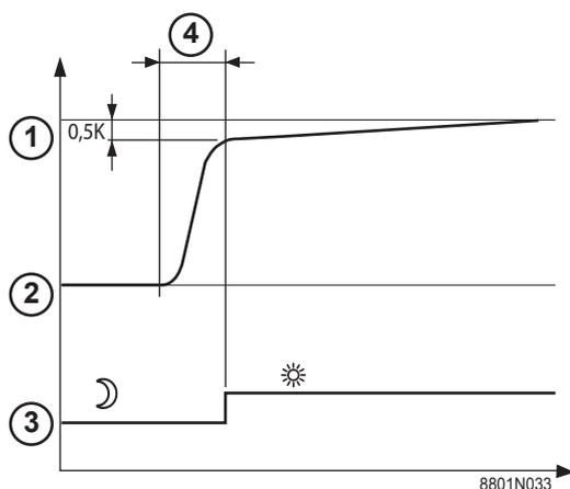
La fonction d'anticipation calcule l'heure de redémarrage du chauffage pour atteindre la température ambiante désirée moins 0,5 K à l'heure programmée du passage au mode confort. L'heure de début du programme horaire correspond à la fin de la phase de réchauffage accéléré.
