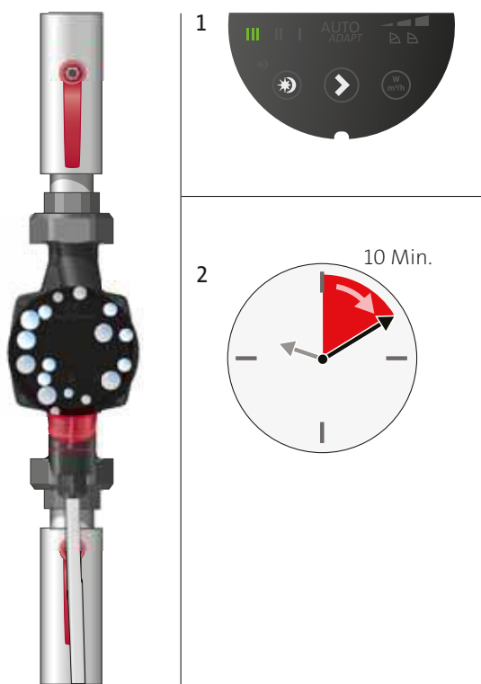
Fig. 13 Purge du circulateur
